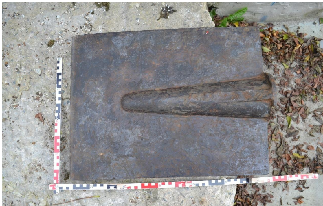
Obr. 19. Skalice čp. 269 (CL), ze zásypu vyjmutý lopatový čep hřídele vodního kola. Foto M. Kolka, 2014.
