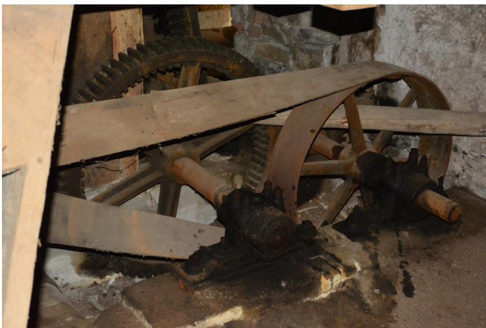
Obr. 6. Žďárec u Skutče čp. 37 (okr. Chrudim). Litinový věnec s dřevěnými palci a malá předlohová hřídel s řemenicí pro plochý řemen. Foto R. Urbánek, 2017.
