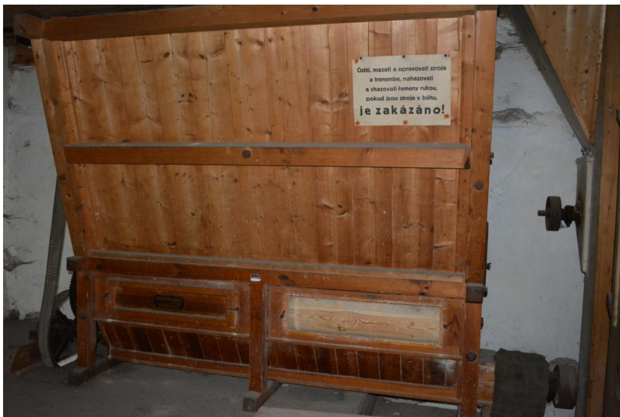
Obr. 8. Žďárec u Skutče čp. 37 (okr. Chrudim). Válcová horizontální míchačka firmy Machaň a spol. továrna na stroje Pardubice. Foto R. Urbánek, 2017.
