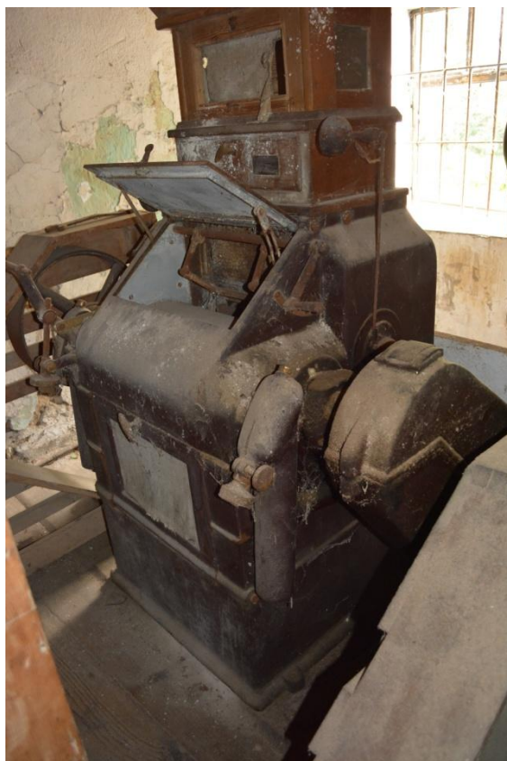
Obr. 9. Žďárec u Skutče čp. 37 (okr. Chrudim). Jednopárová válcová stolice s porcelánovými válci firmy Josefa Prokopa synové Pardubice. Foto R. Urbánek, 2017.
