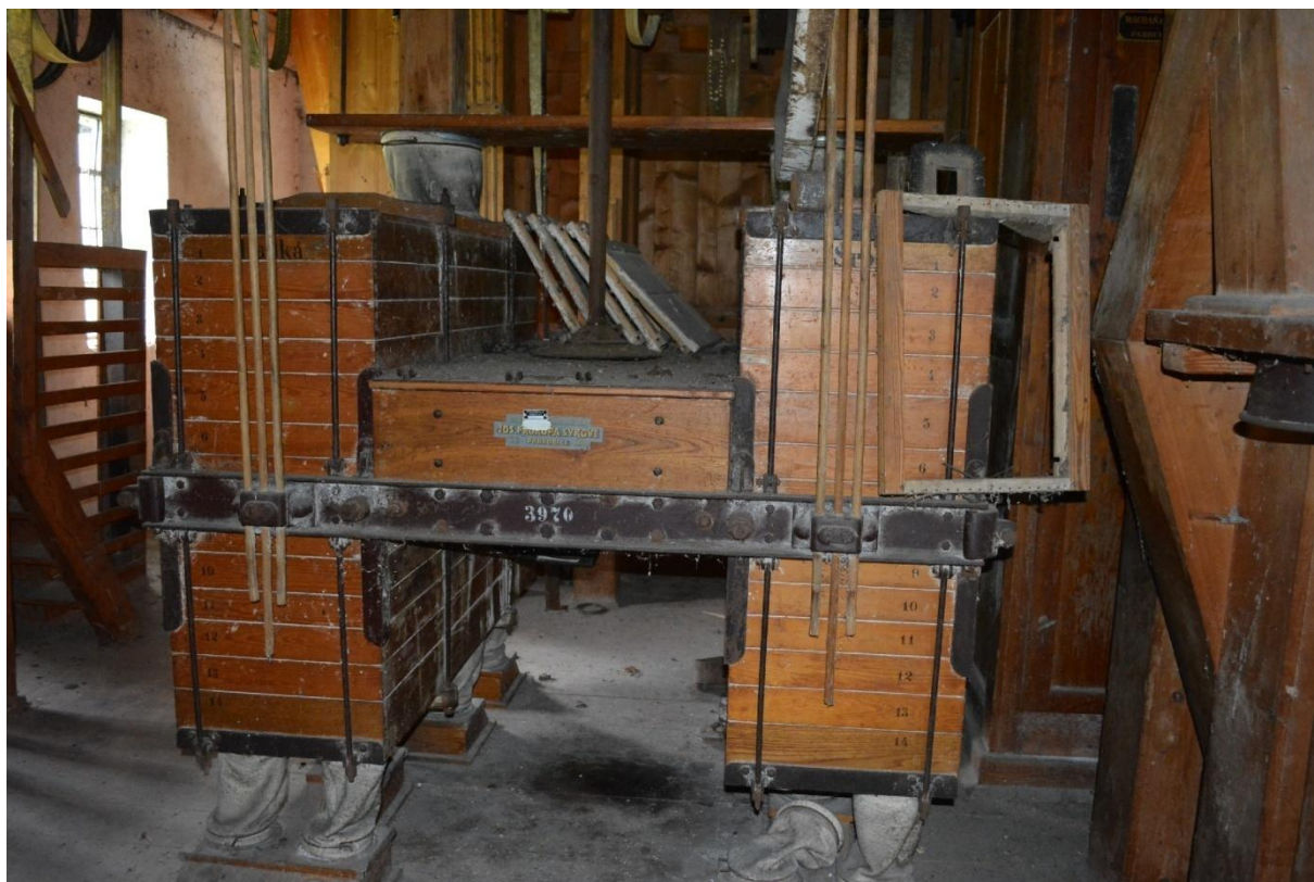
Obr. 7. Žďárec u Skutče čp. 37 (okr. Chrudim). Rovinný vysévač firmy Josefa Prokopa synové Pardubice. Foto R. Urbánek, 2017.
