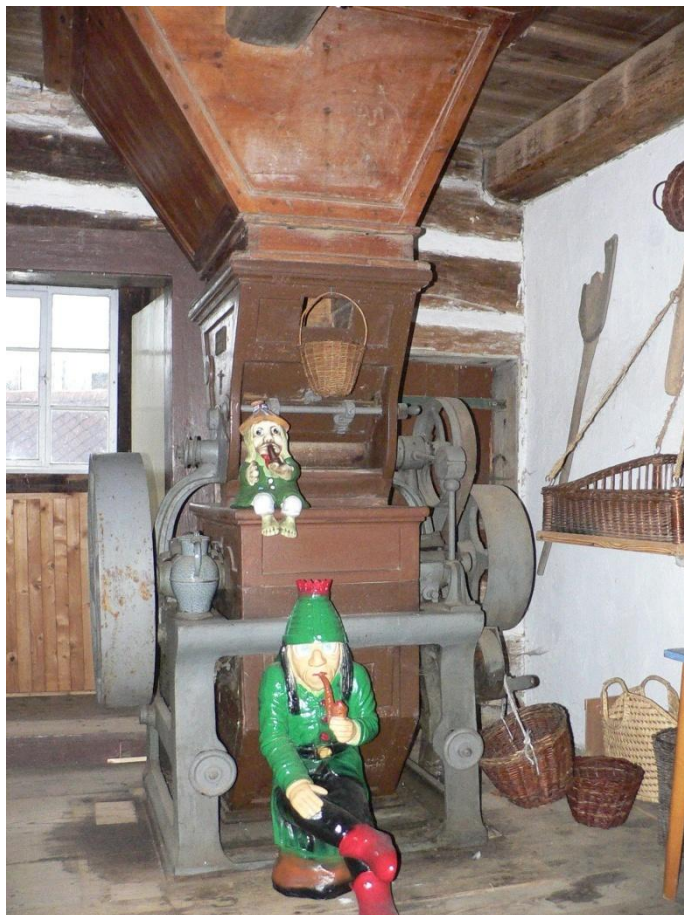
Obr. 18. Sloup čp. 117 (CL), válcová stolice od firmy C. Andrae Oybin v přízemí mlýnice. Foto M. Kolka, 2008.
