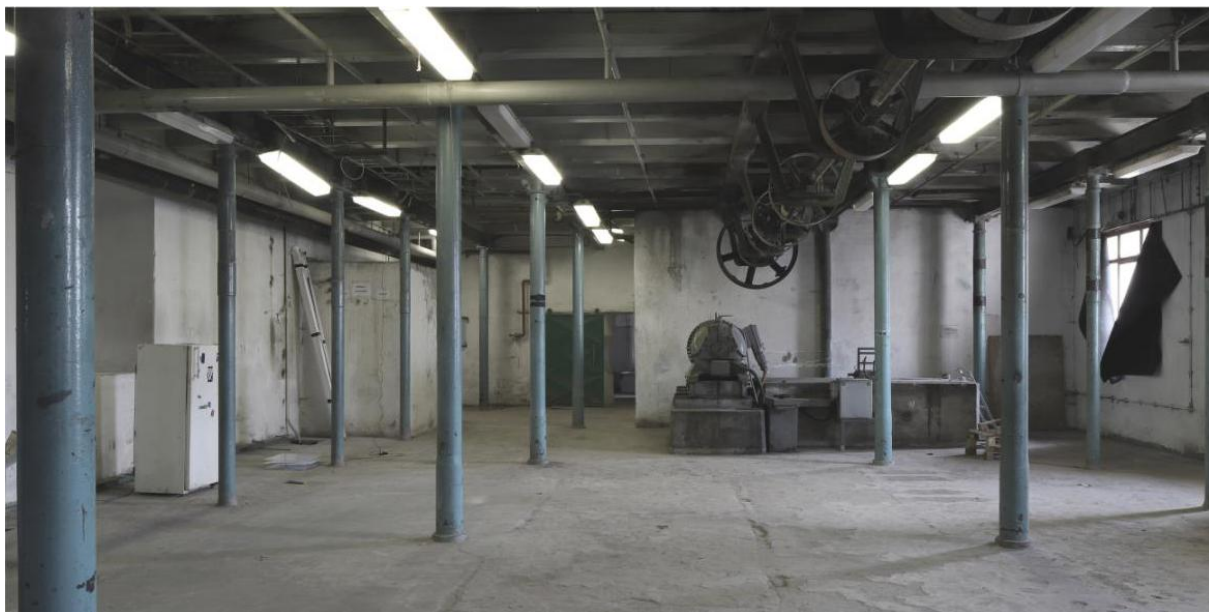
Obr. 5. Pardubice čp. 436, 1. NP mlýnice s motorem a hlavní hřídelí. Foto Ateliér TRANSAT architekti, 2017.
