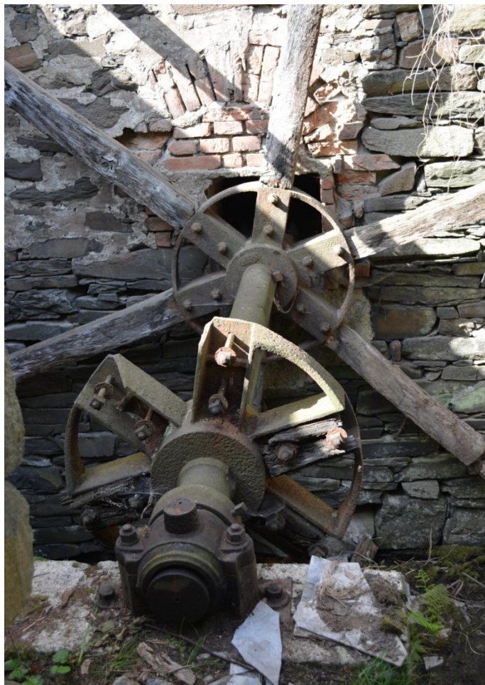
Obr. 5. Žďárec u Skutče čp. 37 (okr. Chrudim). Torzo kovové hřídele s litinovou rozetou. Foto M. Křivanová, 2017.
